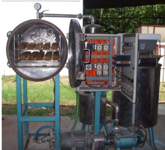
Hình 2.9. Thiết bị sấy chân không gỗ Cắm xe
